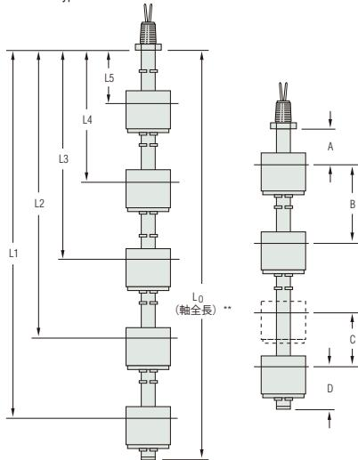
\* 動作レベルの距離とL<sub>0</sub>(全長)は取付部プラグ、フランジの内側面を基準に計測。
