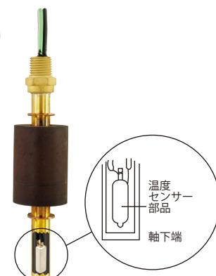
注: レベル・スイッチが動作するには、ユニットの軸端が70mm以上液体に浸っている必要があります。
