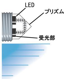
プリズム部分が空気中にある際は、空気とプリズム部分の屈折率の差が大きいため、LED光は、全反射し受光部に入ります。一方、プリズム部分が液中にある時は、プリズム部分と液体との屈折率の差が小さいため、LED光は、液中へ拡散し受光部に戻りません。この現象を利用し、液体の有無を検出します。
