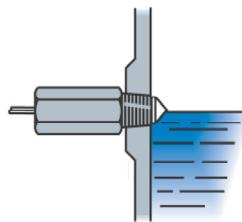
レベル検知したい部分の横にねじ込むことで液面レベル検知にご使用いただけます。
