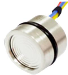
PCM10シリーズは超小型にも関わらずアンプ内蔵且つ高精度な圧力センサです。ステンレススチールSUS316Lのダイアフラムを採用することで、さまざまな液体や気体にご使用いただける上、超小型のため設置場所を選ばず、また使用温度範囲も広いため、さまざまご用途にてご活用いただけます。
