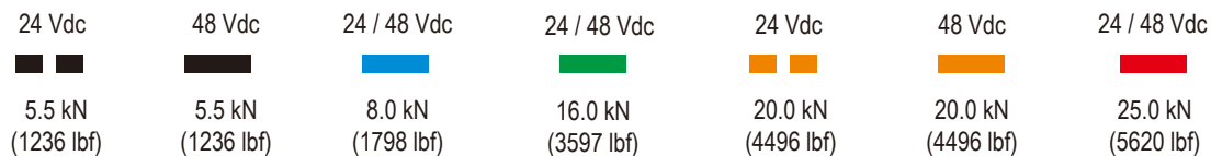
型式ごとの最大推力 (動作時) と電源電圧タイプ
