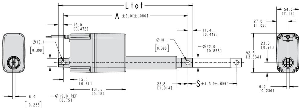
A:最小寸法長、A=S(ストローク長)+133.2mm
